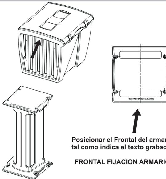
•Para una correcta fijación verificar que la base sea firme, este nivelada y sea uniforme. Realizar la fijación mediante tacos de entre 12/14 mm y tornillos de 10 mm.
