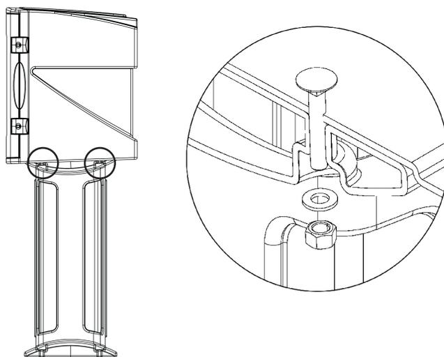
•Fijar las dos partes mediante los tornillos DIN-603 suministrados. Prestar especial atención a la correcta colocación de la arandela.
