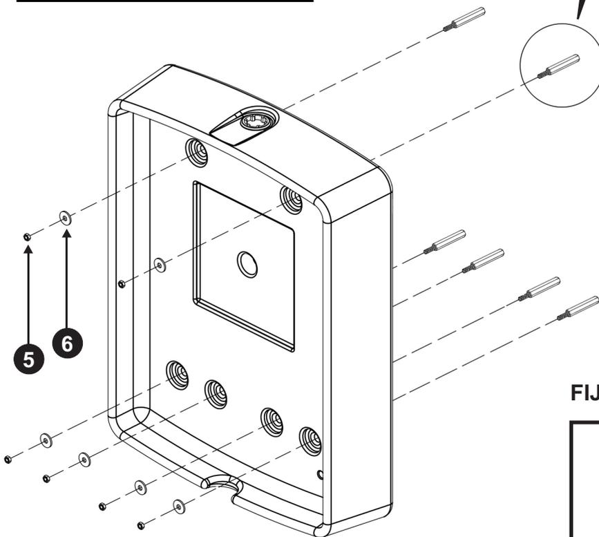
**FIJACIÓN DEPOSITO ESPUMÓGENO**
