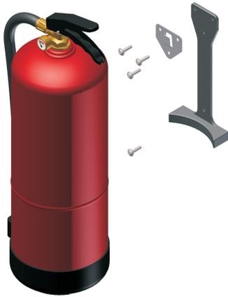
Fijar el soporte Sujeta extintor "Y", utilizando el gancho metálico suministrado con el extintor. Utilizar el gancho metálico como plantilla para taladrar el soporte, en el caso de que no coincida con el agujero existente. El tornillo inferior es opcional.
